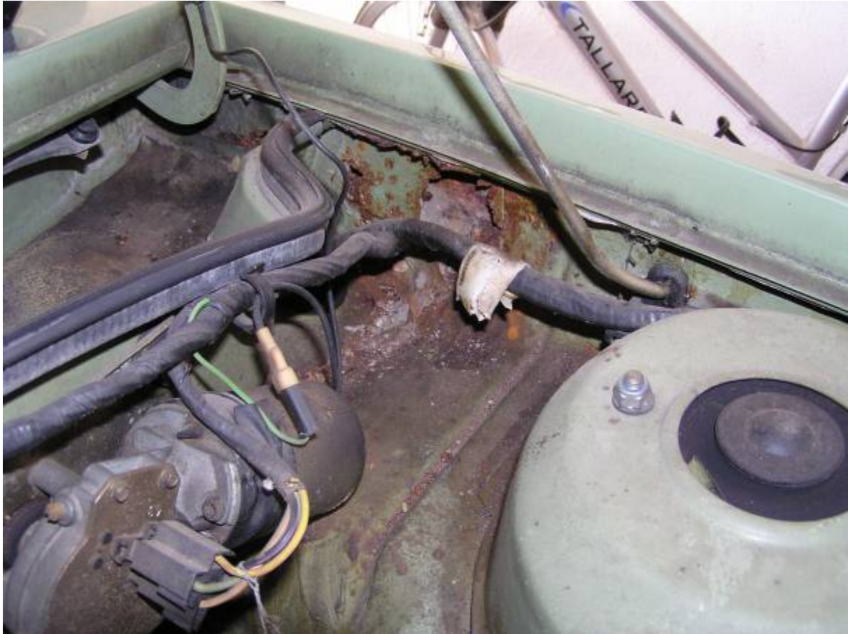
Bild 2: Korrosion zwischen Federbeindom und Wasserkasten
