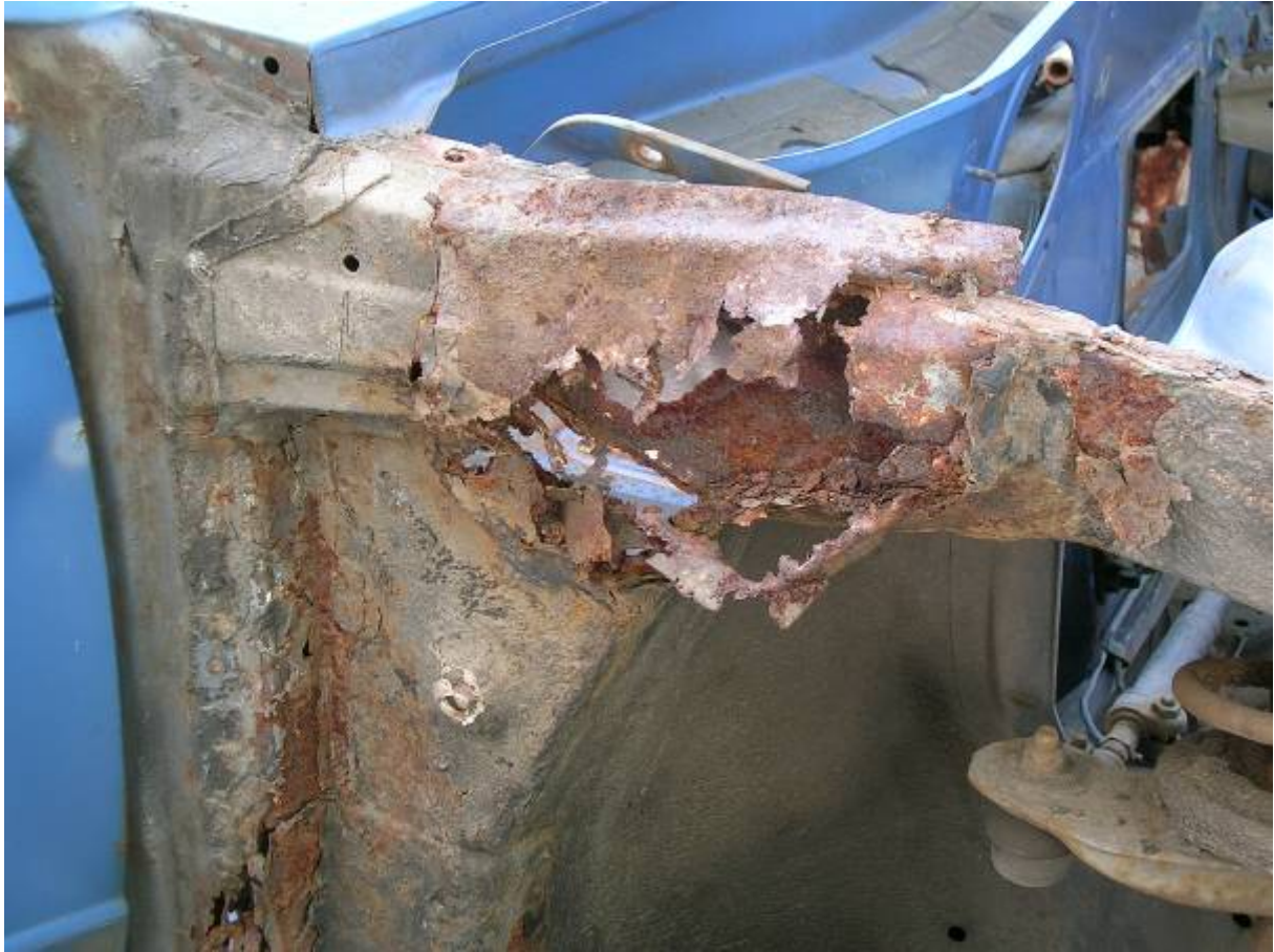
Bild 4: Radhausstrebe in fortgeschrittenem Zerfall
