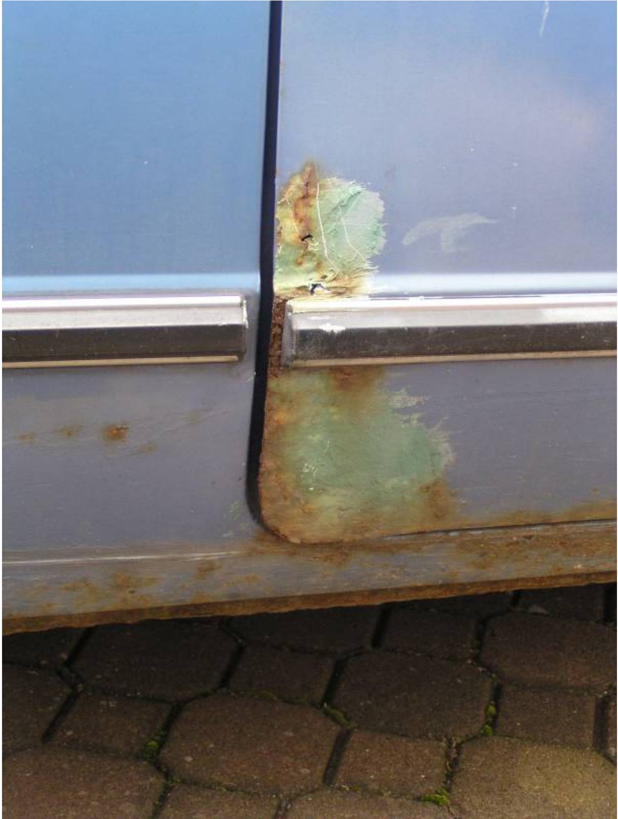
Bild 15: Hintere Ecke der Beifahrertür in fortgeschrittenem Zerfall
