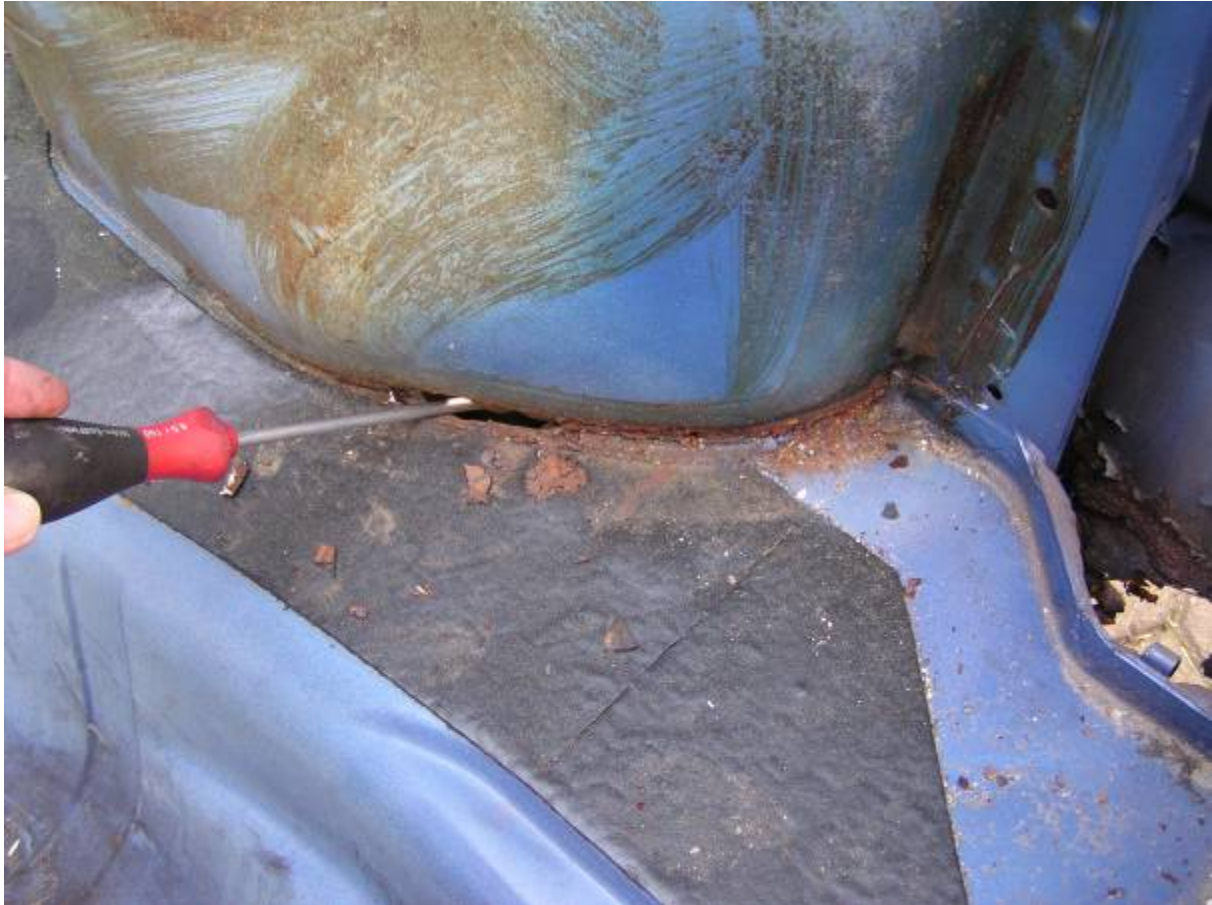
Bild 14: Der Übergang vom Kofferraumboden zum hinteren Radhaus
