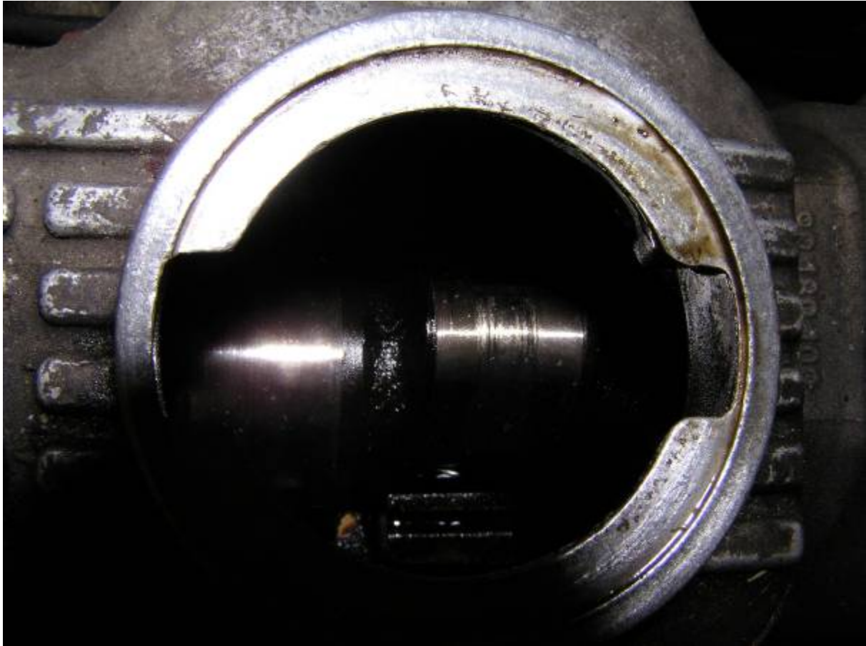
Bild 17: Eingelaufene Nockenwelle erkennbar am Nocken des 1. Zylinders durch den Öleinfüllstutzen
