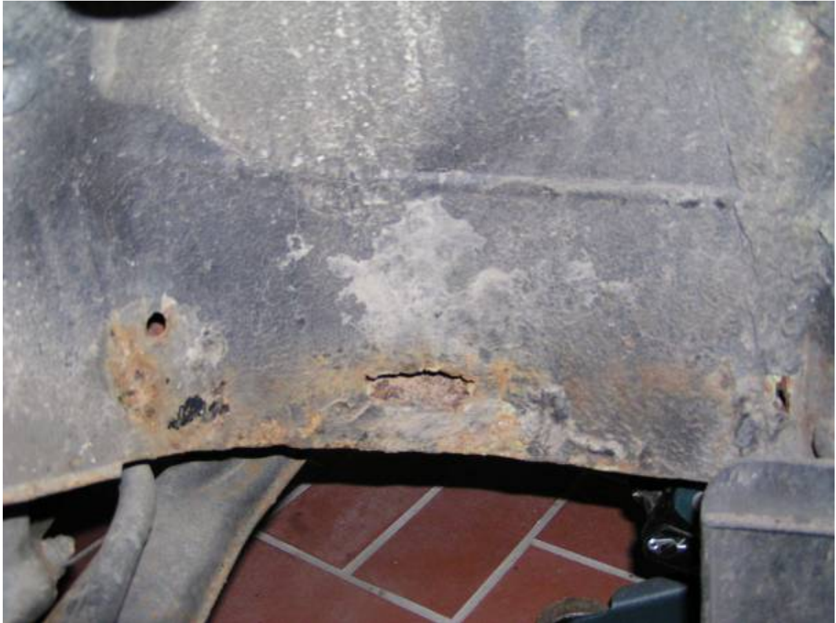
Bild 8: Radhaus am hinteren Bereich des Länsträgers
