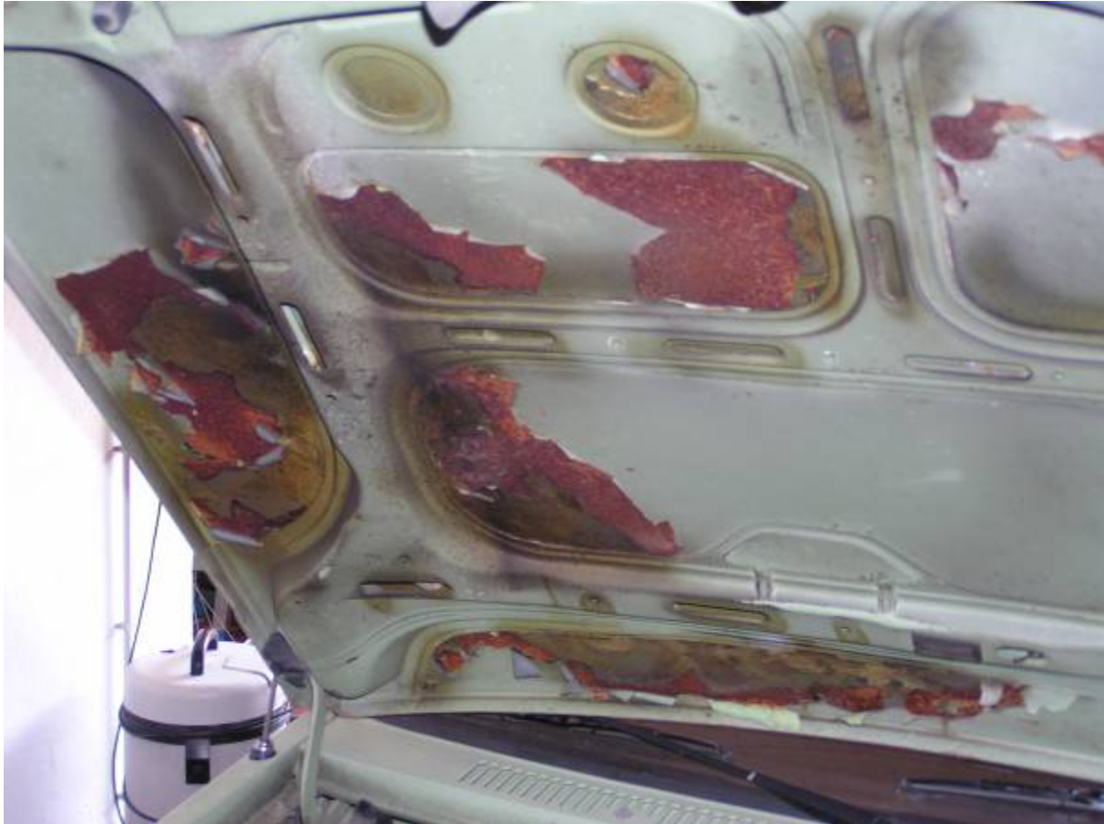
Bild 16: Unterseite Motorhaube –lack blättert großflächig ab
