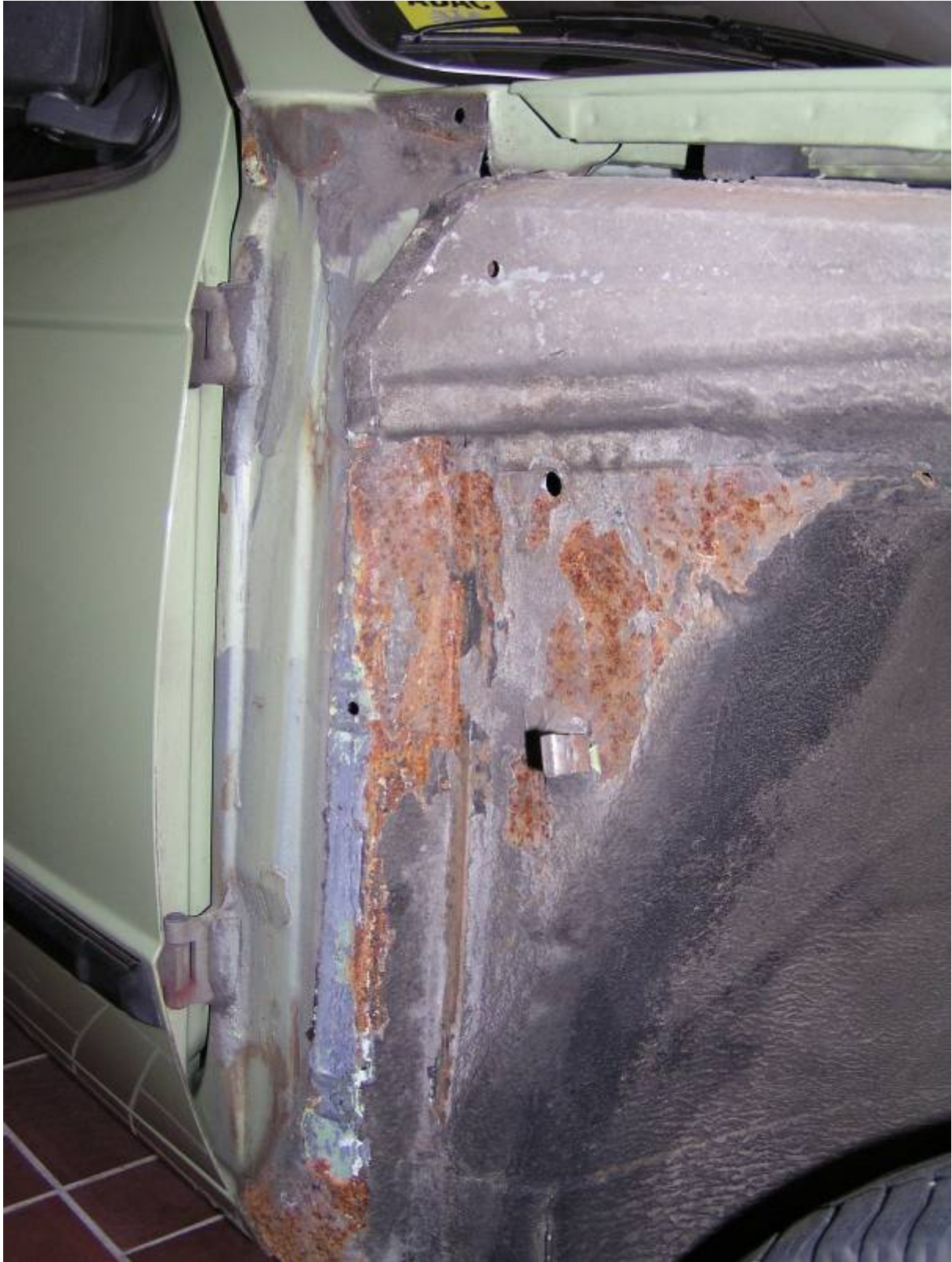
Bild 3: Erst bei demontiertem Kotflügel sind der Zustand von Radhausstrebe und A-Säule genau zu inspizieren
