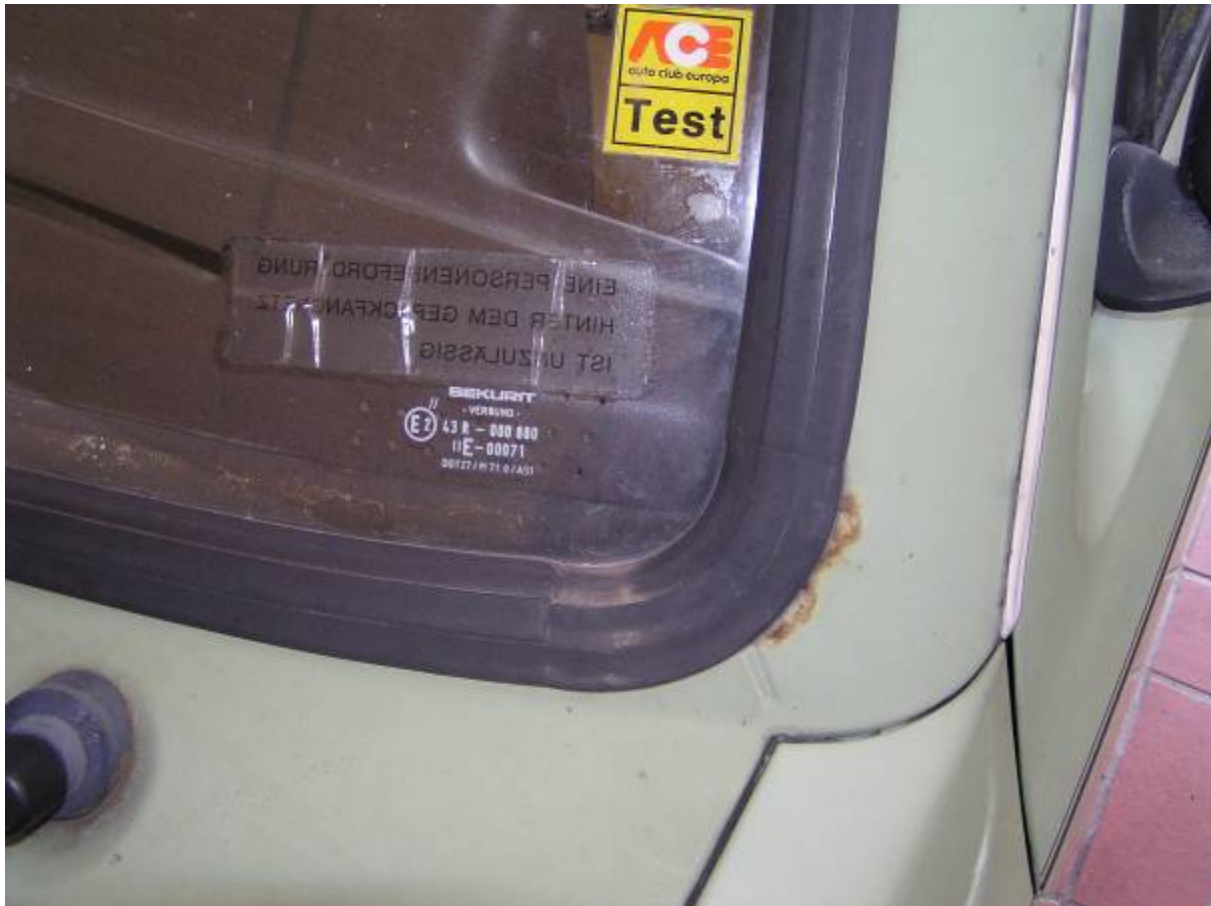
Bild 10: Korrosion am Scheibenrahmen
