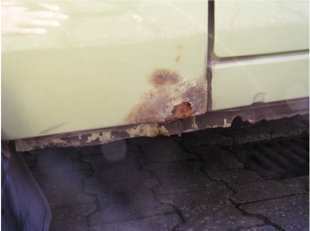
Bild 5: Verdächtige Rostblasen an der Kotflügelendspitze
