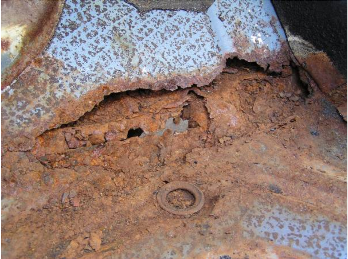
Bild 11: Bodenblech unter Pedalerie mit "freien Blick" auf die vordere Querlenkeraufnahme
