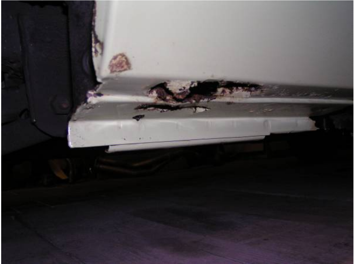
Bild 12: Schwellerende mit starker Korrosion
