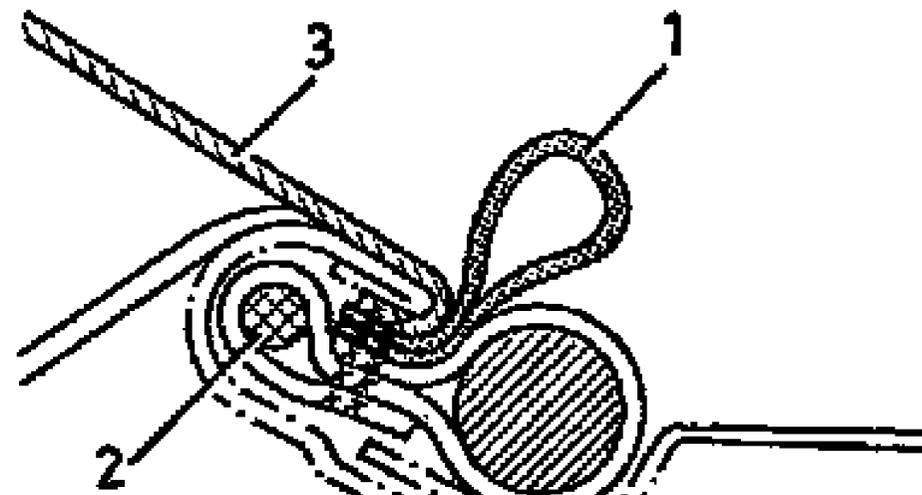
Spanndraht von der Mitte aus gleichmäßig nach beiden Seiten hin mit der Hand eindrücken.
