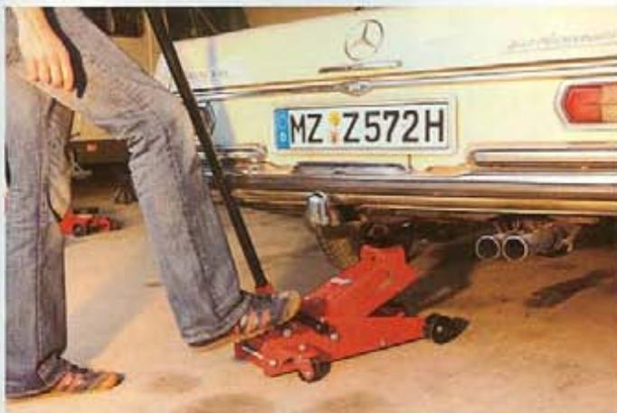
Die Schnellhubfunktion (hier beim Rodac-Dreitonneur) spart viele Pumpenhübe, bis der Aufnahme-Teller am Wagen anliegt
