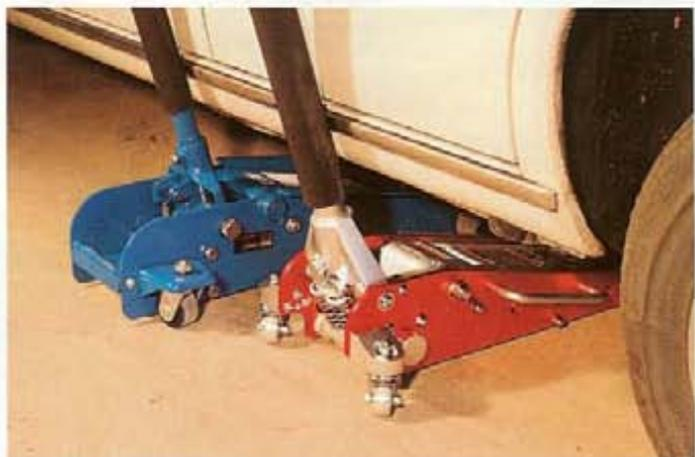
Sinnvoller Kantenschutz: Die Schaumstoffummantelung der Pumpstange schützt das Auto, ist aber nicht immer serienmäßig
