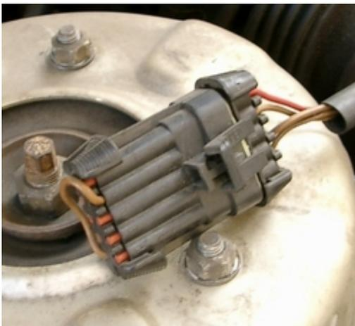
Diagnosesteckerkappe mit Überbrückung PIN G und PIN A
