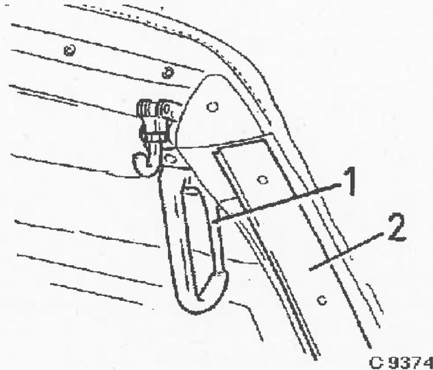
Spanndraht der seitlichen Polsterauflage lösen.
