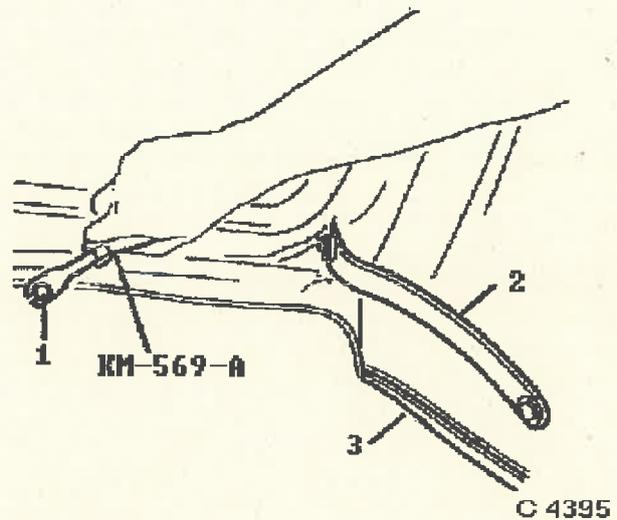
Hintere Befestigungsschraube der Seitenwandverkleidung heraus-schrauben.
