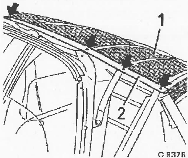
Nietköpfe der Spanngurtbefestigung vom Spriegel abbohren (4 Niete).
