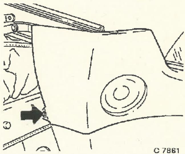
Spanndraht 2 der Außenbespannung abschrauben.
