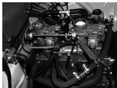
Vergaseranlage 2 x 35 PDSI, MJ 69, Ansicht von rechts
