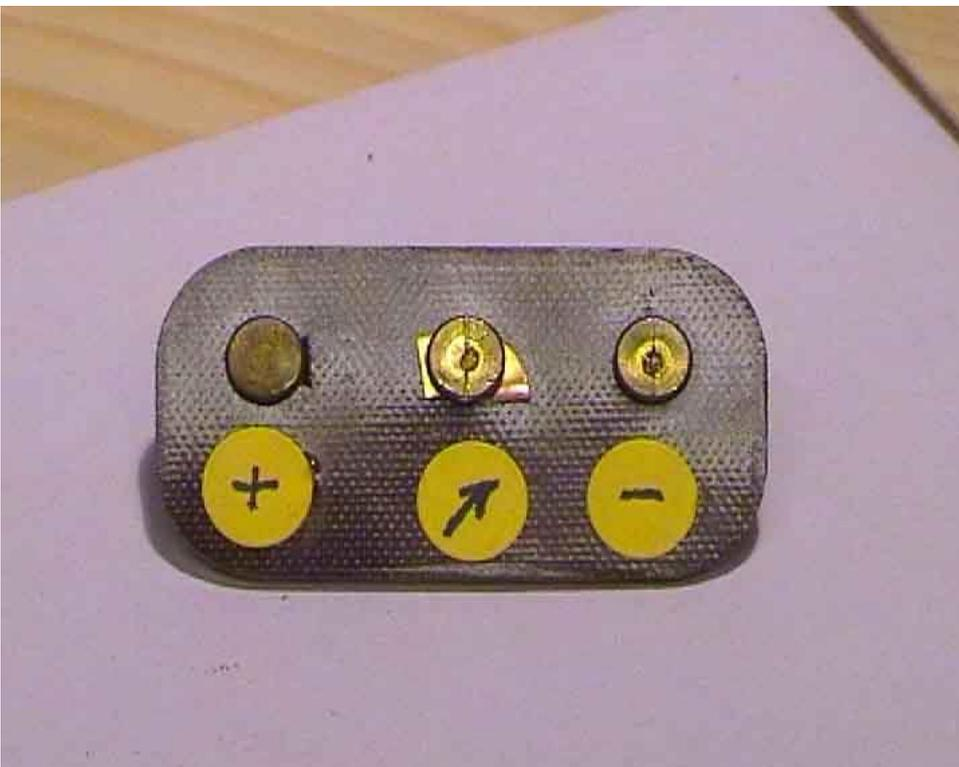
**Die Nieten werden verzinkt, dann ist anschließend das Lötten leichter**
