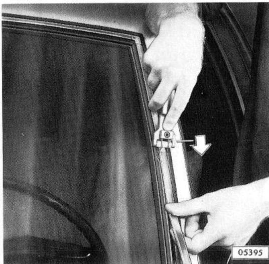
Zierstreifen mit S-1284 einlegen und Verbindungstücke an den Ecken einsetzen.
