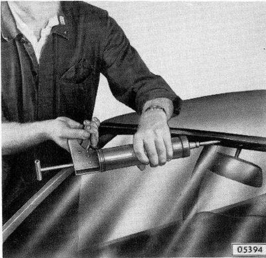
Zwischen Außenseite Windschutzscheibe und Gummifassung Flachdüse der Druckpresse einführen und ringsherum mit Fensterdichtungsmasse auslegen - an der Windschutzscheibe gezeigt.
