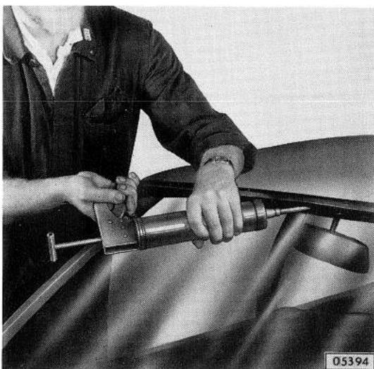
Zwischen Außenseite Windschutzscheibe und Gummifassung Flachdüse der Druckpresse einführen und ringsherum mit Fensterdichtungsmasse auslegen.
