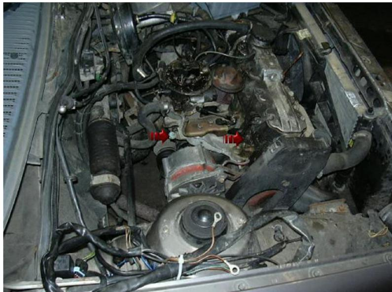
1) Kabelbaum der Einspritzanlage komplett entfernen. Es sieht schwieriger aus wie es ist. Beide Masseschrauben am Nockenwellengehäuse abschrauben. Alle Steckverbindungen trennen. Absolut Narrensicher man kann nichts vertauschen. Klemme am Temperaturegeber nicht vergessen.
