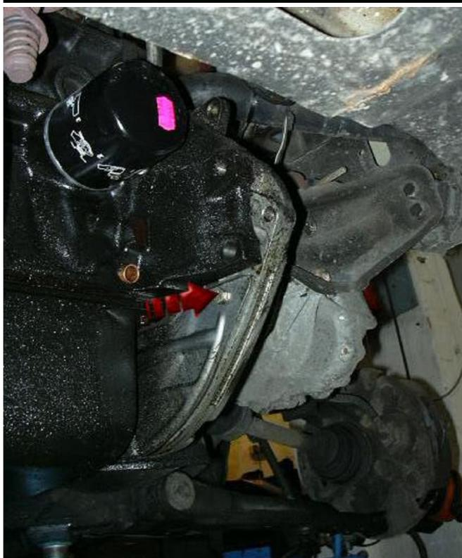
1) Alle Schrauben (6) rund um das Getriebe entfernen. Auch den kleinen Blechdeckel ( 11 er Schlüsselweite 3 Schrauben) nicht vergessen. Nicht den gebogenen auf der Getriebeseite (4 Schrauben). Dieser wird nur beim Opel Vectra (Servo) entfernt. Mann muss dann vorher den Automaten ausbauen. Sonst wird es einfach zu eng beim herausheben. Oder du willst nur die Kupplung wechseln, dann benötigst du zusätzlich 3Halteklammern AS 400 0005 10 0.
