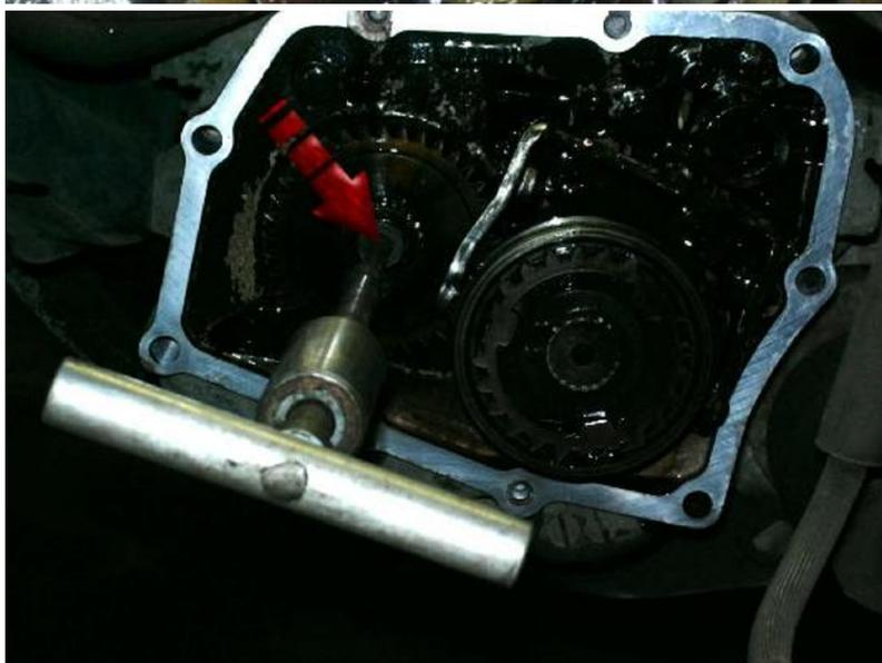
1) Und nun den Auszieher in die Welle drehen. Die Welle bis zum Anschlag herausziehen. Es kann vorkommen das Sie etwas klemmt. Es darf dann sogar etwas Gewalt angewendet werden. natürlich alles im Verhältnis. Aber es gibt Wellen die sind verdammt fest und manche fallen dir entgegen..
