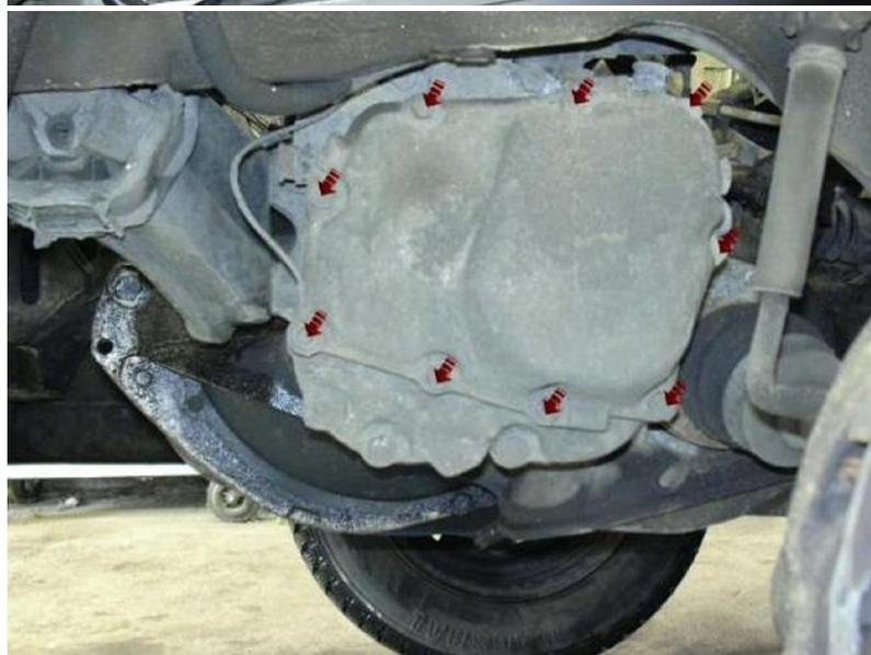
1) Nachdem ihr die Linke Fahrzeugseite hochgebockt und das Rad entfernt habt seht ihr den Getriebedeckel. Eine Kleine Wanne unterstellen, falls etwas Getriebe Öl ausläuft und dann ab mit dem Deckel. Na klar hab ich die Neue Dichtung schon besorgt, oder?
