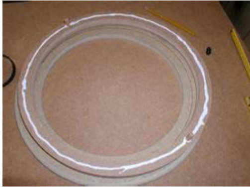
Leim auftragen und zusammenfügen
